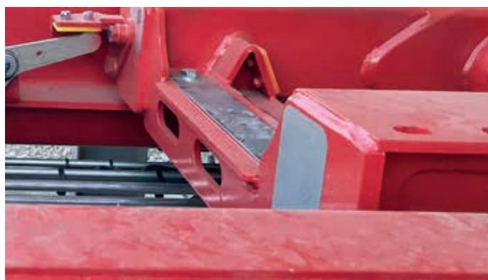
Clapet sur bras (interdit les manœuvres en condition de bennage)
